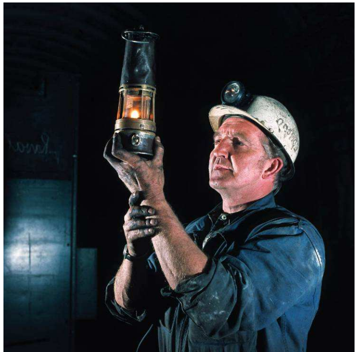
Mesure du grisou avec une lampe à alcool.
